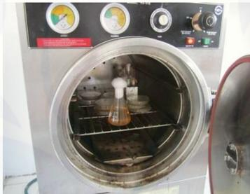
Gambar 3.6 Media BHI-A disterilisasi menggunakan *autoclave*
