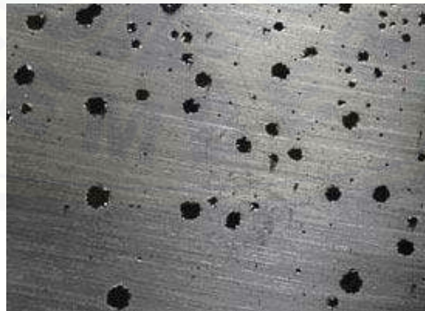
Gambar 2.9 Korosi Sumuran (Sumber: Budi Utomo, 2009)
