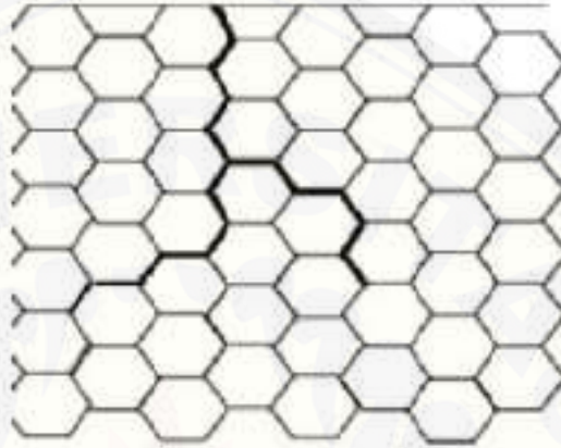
Gambar 2.10 Skema Korosi Antar Batas Butir (Hakim, 2012)
