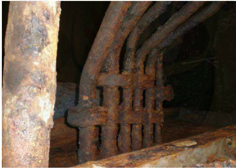
Gambar 2.1 Korosi Seragam Pada Pipa Ballast (Utomo, 2009)
