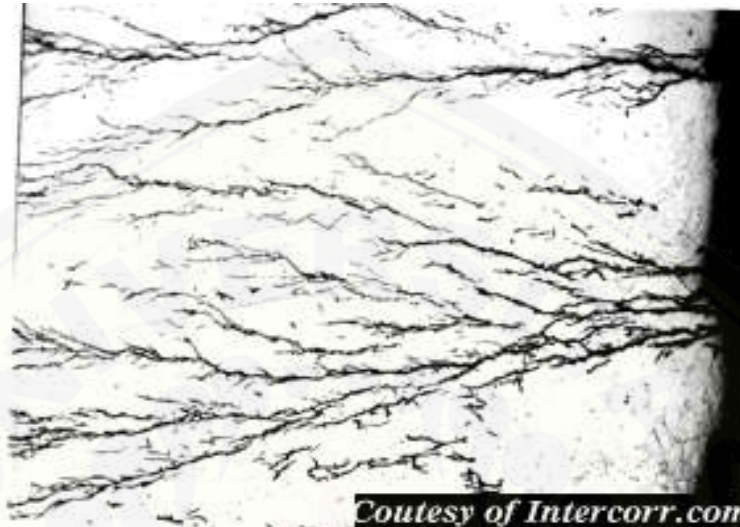
Gambar 2.5 Korosi Tegangan (Utomo, 2009)
