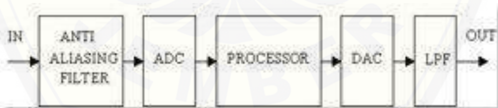
Gambar 2.9 Blok diagram sistem pemrosesan sinyal pada DSP ( http://pradinipus.wordpress.com/2011/05/06/232/ )
