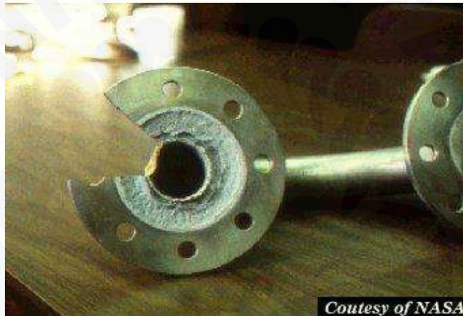
Gambar 2.6 Korosi Celah (Sumber: Utomo, 2009)
