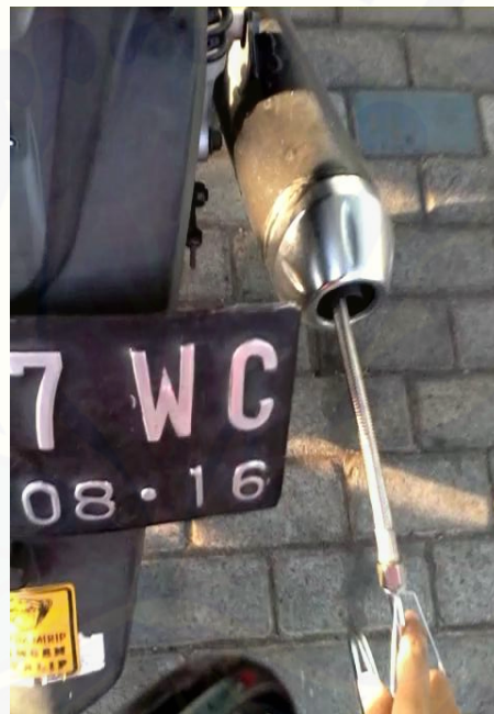
Gambar 3.6 Proses peletakan sensor emisi
