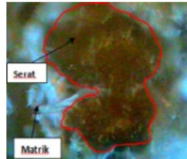
Gambar 8. Struktur Mikro Tekanan 9 Bar perbesaran 100x
