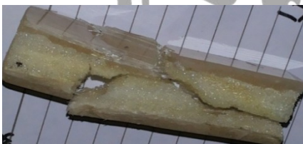
Gambar 4. kegagalan kekuatan impact komposit sandwich
