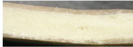
Gambar 6. kegagalan spesimen uji bending fraksi berat serat 20%
