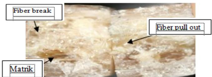
Gambar 6. Bentuk patahan spesimen uji impact panjang serat 50 mm dan fraksi volume 20%
