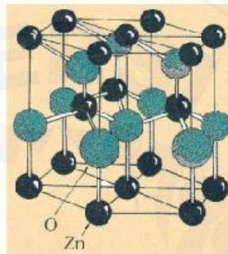
Gambar 2.1. Struktur wurtzite heksagonal ZnO. Atom O ditunjukkan sebagai bulatan besar, atom Zn sebagai bulatan kecil (Sumber : Coleman dan Jagadish, 2007)
