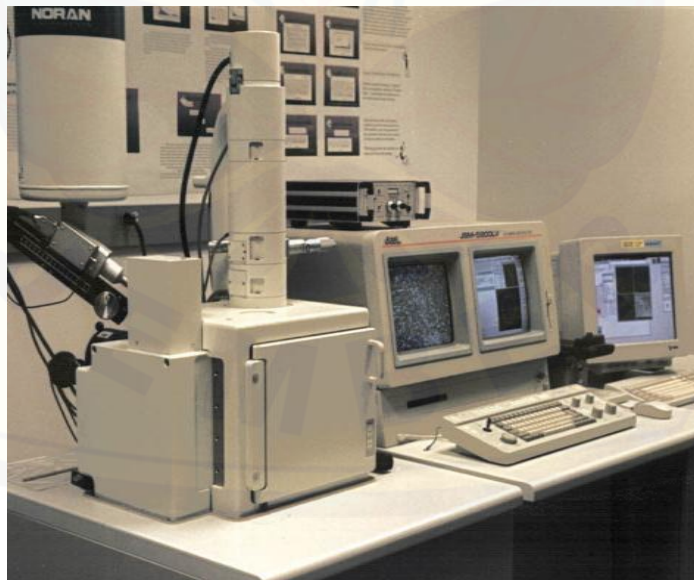
Gambar 2.12 Peralatan Scanning Electron Microscopy (SEM) dan Energy Dispersion Spektroskopi (EDS) . merek JOEL tipe JSM 6360 LA (Sumber: Schoder,D.K, 2005 ).
