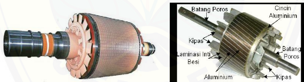
Gambar 2.2. Rotor Sangkar, (a) Tipikal Rotor sangkar, (b) Bagian-Bagian Rotor sangkar. (Eko prasetyo, 2010)
