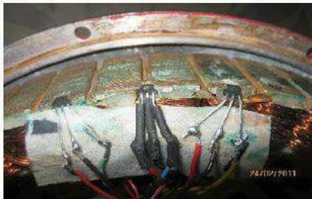
Gambar 2.8 Penempatan Sensor Hall pada Stator
