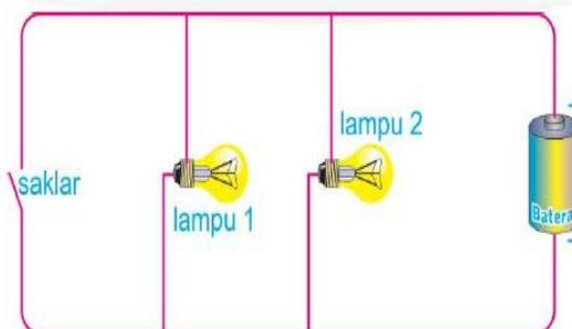
Gambar 9.3 Rangkaian listrik paralel pada lampu
