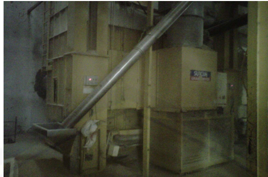
Gambar 4.6 Alat pengering gabah di RMU PB. Tunggal Perkasa Kecamatan Mayang menggunakan energi panas sekam (14 Mei 2014)
