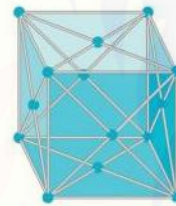
Gambar 2.5 Struktur atom Nikel dan struktur kristal Nikel
