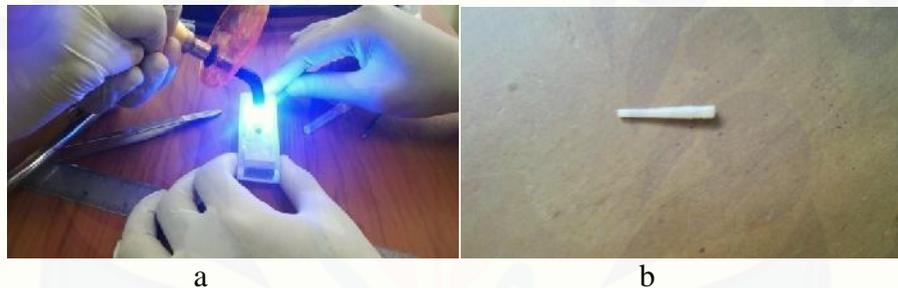
Gambar 3.8 a. Proses *curing* b. Hasil Pembuatan pasak PFR
