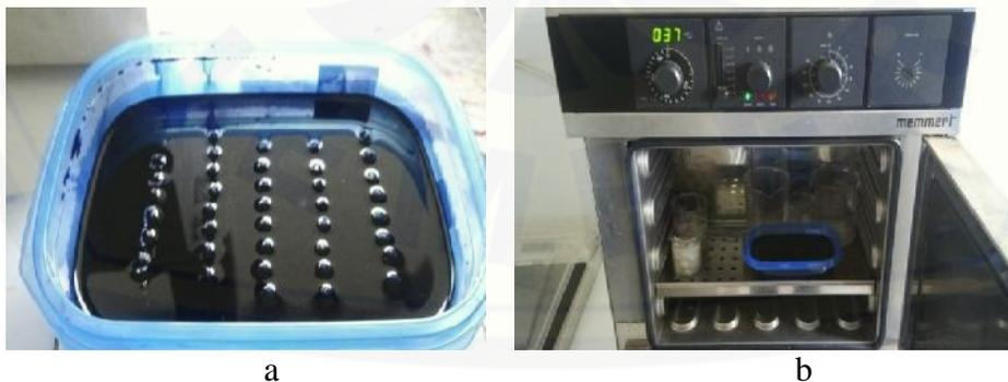
Gambar 3.12 a. Merendam sampel dalam *methylen blue* 0,25% b. Memasukkan sampel dalam inkubator
