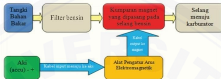
Gambar 2.11 Alur Pemasangan Alat Elektromagnetik Penghemat Bahan Bakar
