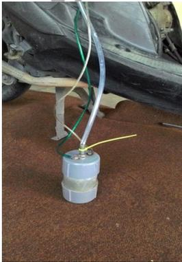
Gambar 1. Alat elektrolisis
