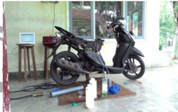
Gambar 3. Pengujian Menggunakan Gas Analyzer
