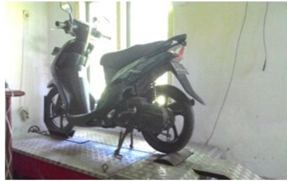
Gambar 2. Pengujian Menggunakan Dinamometer
