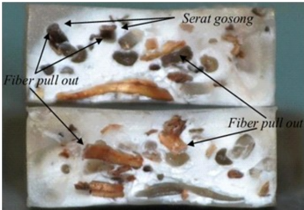
Gambar 5. Patahan spesimen uji tarik fraksi berat 12 % dan panjang 7 mm
