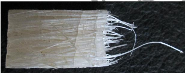
Gambar 6. Patahan Spesimen uji *bending* dengan variasi volume *filler* 60%
