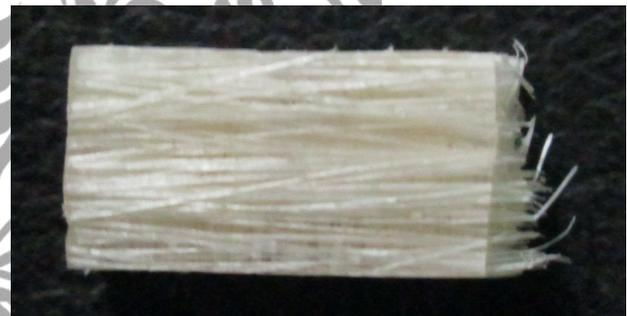
Gambar 4. Patahan Spesimen uji *bending* dengan variasi volume *filler* 40%
