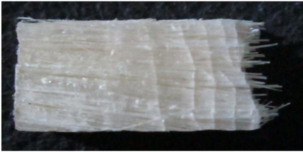
Gambar 5. Patahan Spesimen uji *bending* dengan variasi volume *filler* 50%
