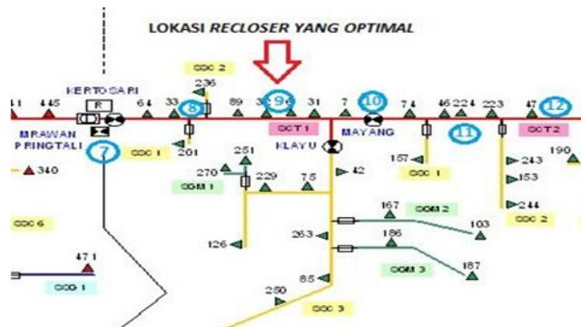
Gambar 6. Penempatan *Recloser* yang optimal pada Penyulang Mayang
