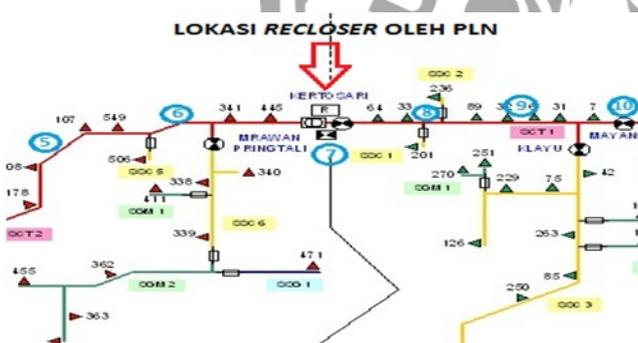
Gambar 7. Penempatan *Recloser* yang diletakkan oleh PLN pada Penyulang Mayang
