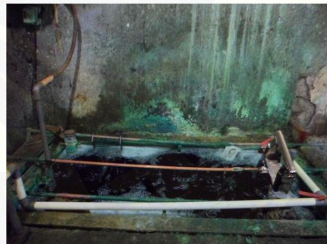
Gambar 10. Proses Pelapisan Nikel
