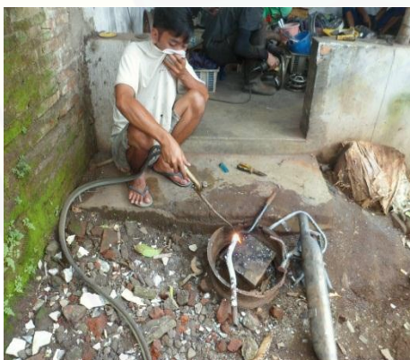
Gambar 3. Menghilangkan Lapisan Cat pada Bahan Besi
