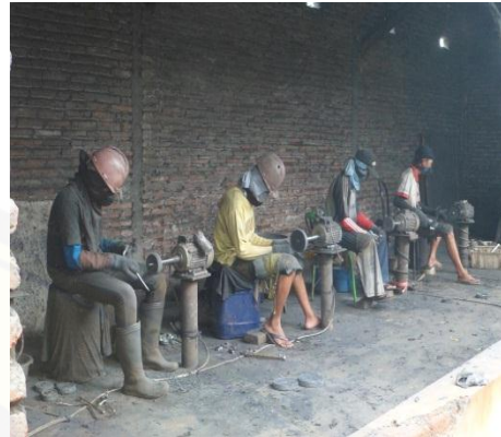
Gambar 6. Proses Mempoles dan Rampalas
