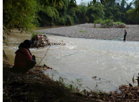
Gambar 18. Pengukuran Lebar dan Kedalaman Sungai
