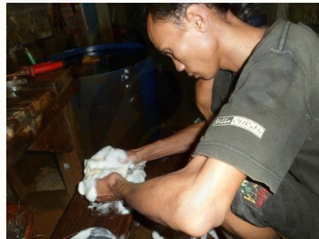
Gambar 8. Proses Pencucian Sebelum Bahan Dilapisi Logam
