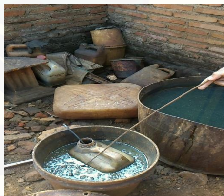
Gambar 4. Menghilangkan Lapisan Karat pada Bahan
