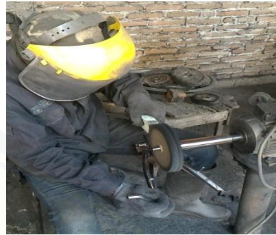
Gambar 12. Proses Penyikatan dengan Batuan Hijau
