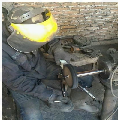
Gambar 4.10 Proses Pengosokan dengan Batu Hijau
