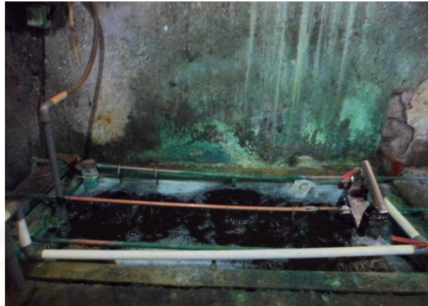
Gambar 4.8 Proses Pelapisan Nikel
