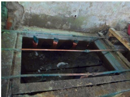
Gambar 9. Proses Pelapisan Tembaga
