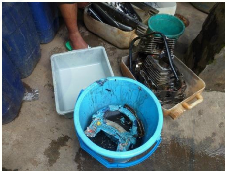
Gambar 1. Menghilangkan Lapisan Cat pada Bahan Aluminium
