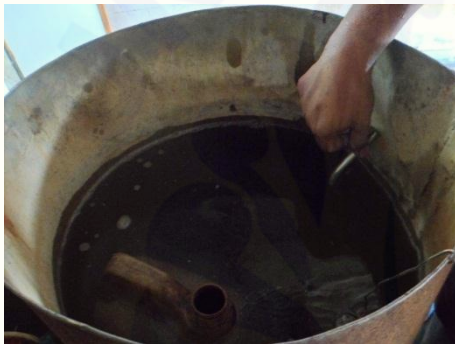
Gambar 7. Proses Menghilangkan Lapisan Minyak dan Lemak
