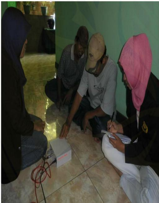
Gambar 7. Pengukuran kelelahan kerja umum responden dengan menggunakan *reaction timer*
