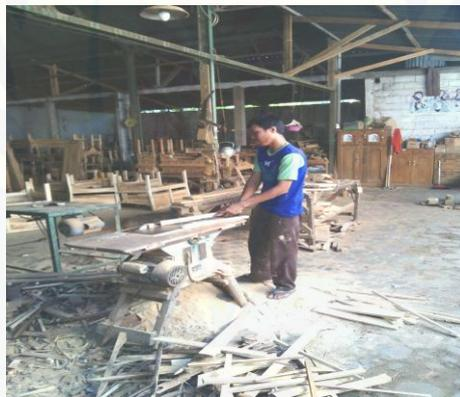
Gambar 2.6 Pemotongan Kayu
