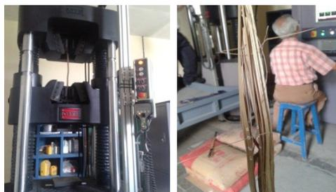
Gambar 4. Pengujian Kuat Tarik Bambu
