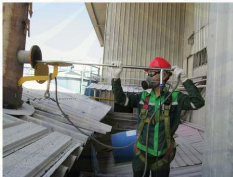
Gambar 4.5 Pemakaian Alat Pelindung Pernafasan pada Petugas Pengambil Contoh Uji Emisi Sumber Tidak Bergerak
