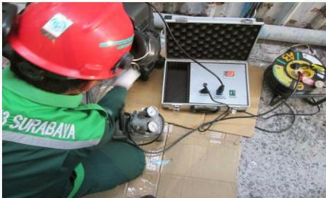
Gambar 4.7 Pemakaian Alat Pelindung Kepala pada Petugas Pengambil Contoh Uji Emisi Sumber Tidak Bergerak
