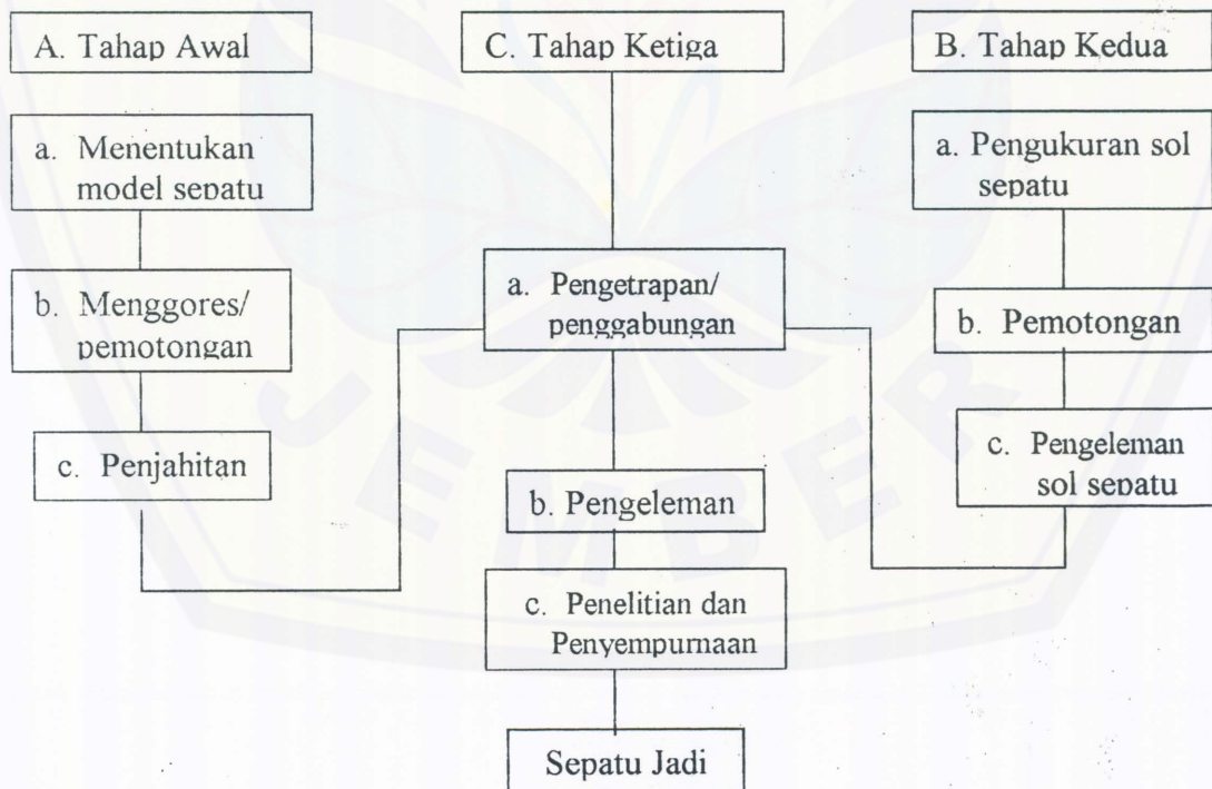
Gambar 4.2: Proses Produksi pada Perusahaan Sepatu Eternal Mojokerto Sumber data: Perusahaan Sepatu Eternal Mojokerto, 2000
