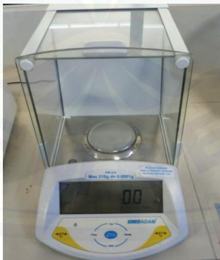
Gambar I.2 Alat penelitian: Timbangan digital untuk menimbang aspirin
