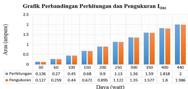
**Gambar 13.** Perbandingan Perhitungan dan Pengukuran Masukan Arus Listrik
