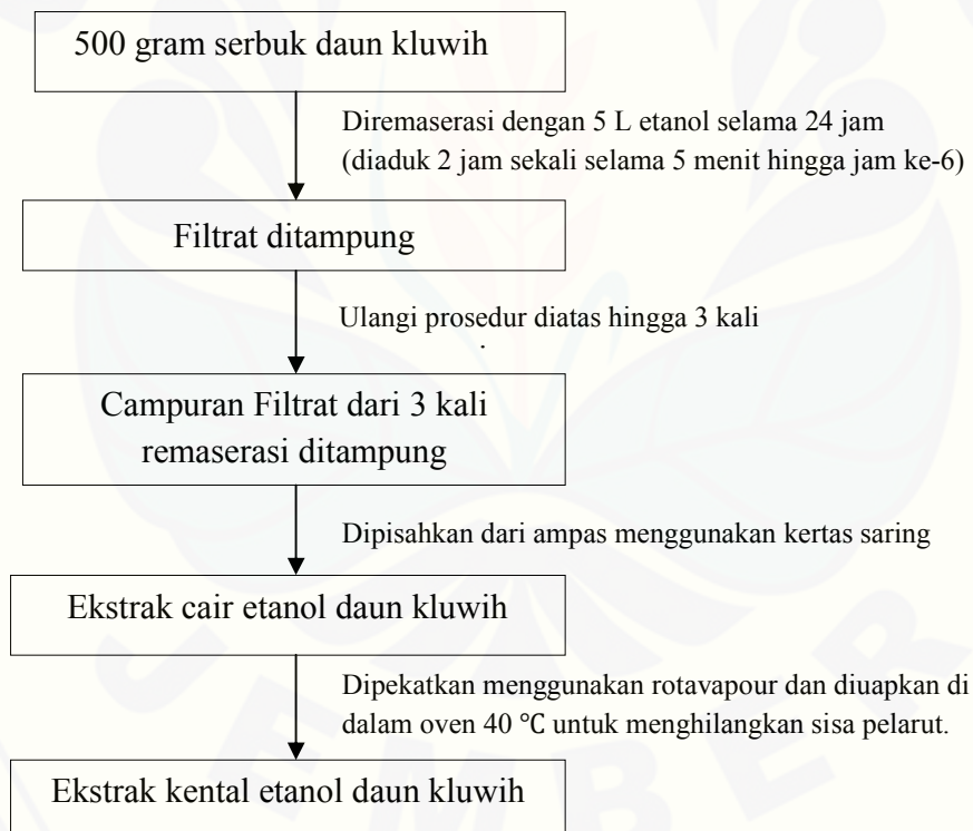
Gambar 3.2 Skema pembuatan ekstrak etanol daun kluwih
