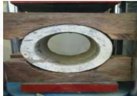
Gambar 18 : Uji tekan hollow silinder
