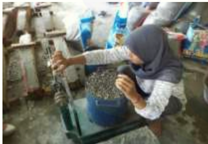
Gambar 3 : Pengujian BV Agregat Kasar (Kerikil)
