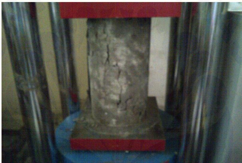
**Gambar 4.5. Gambar Retakan Pada Beton Normal**
