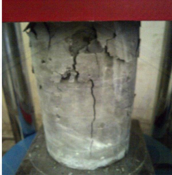
**Gambar 4.8. Gambar Retakan Pada Beton Campuran 2% HDPE**
