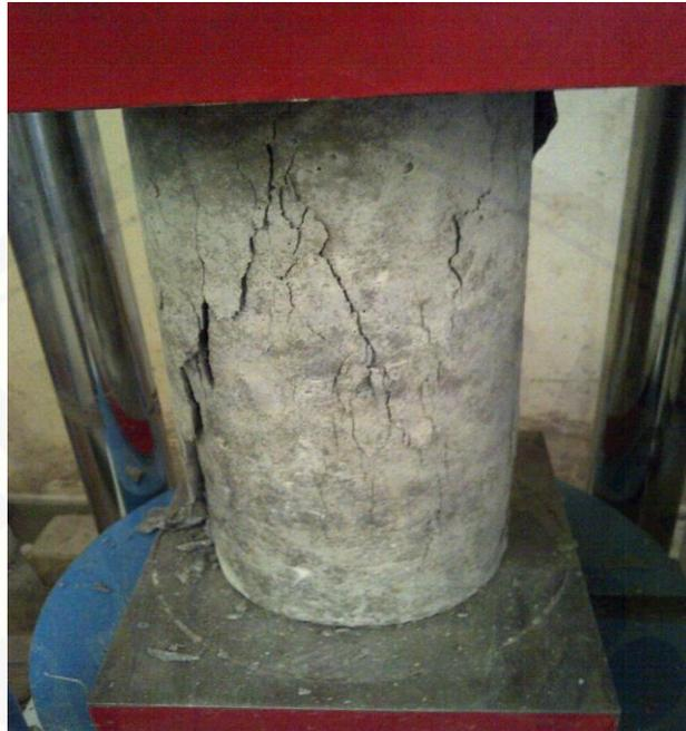
**Gambar 4.6. Gambar Retakan Pada Beton Campuran 1% HDPE**
