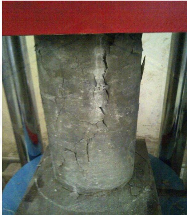
**Gambar 4.7. Gambar Retakan Pada Beton Campuran 1,5% HDPE**
