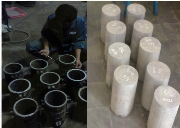
Gambar 4.4 Proses Pembongkaran dan Perawatan Benda Uji Silinder
