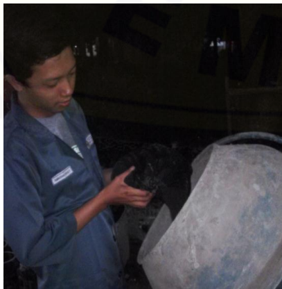
Gambar 4.1 Proses Memasukkan Material Ke Dalam Mixer
