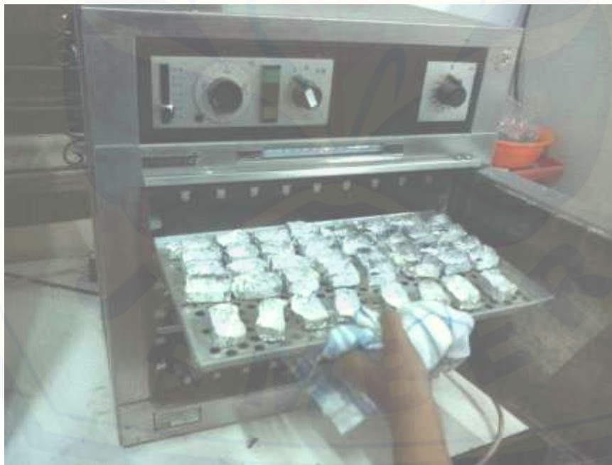
Gambar G.8 Metode oven untuk menentukan kadar air keju jenis cream cheese
