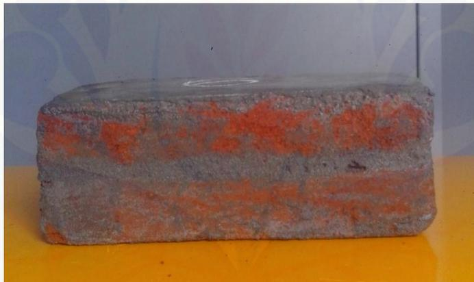
*Gambar 4.1 benda uji dinding pasangan batu bata*
