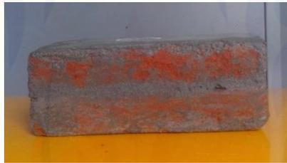
*Gambar 3.1 dinding pasangan batu bata untuk uji tekan*
