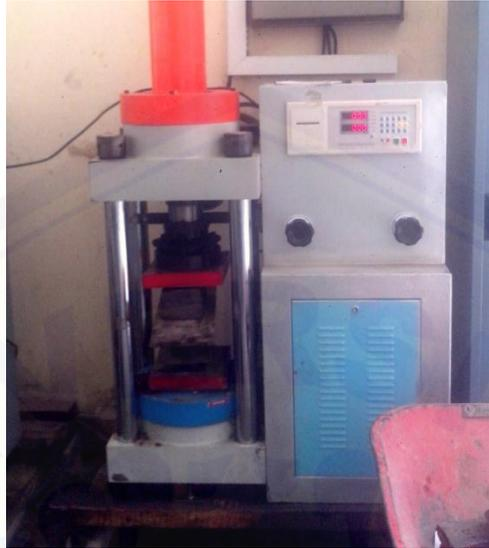
*Gambar 4.2 pengujian benda uji pasangan batu bata*
