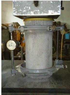
*Gambar 2.5 Tes modulus elastisitas mortar.*
