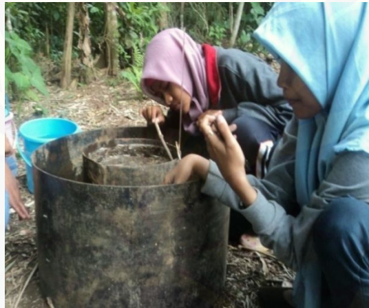
Gambar 4.4 Pengukuran Parameter Infiltrasi Di Lapangan
