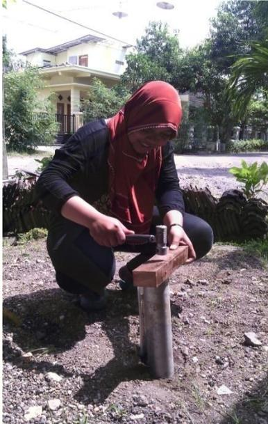
Pemasangan alat uji permeabilita
