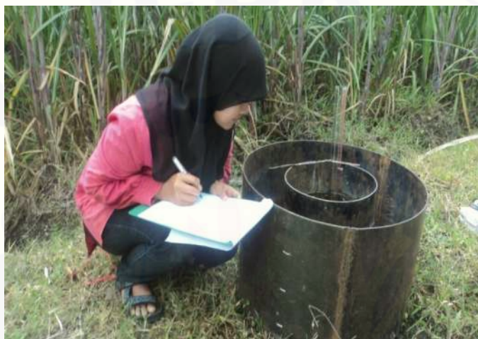
Gambar 4.7. Pengamatan infiltrasi di lapangan
