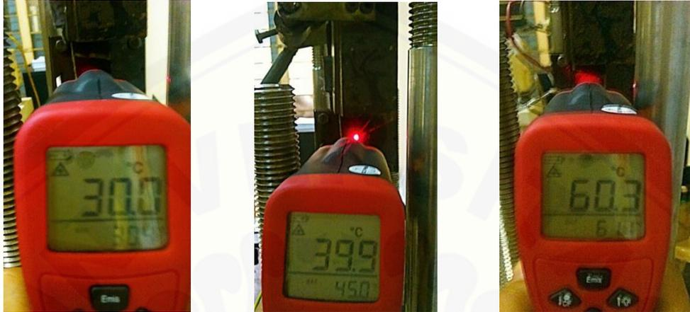
a. Temperatur pada *belt* 30°C      b. Temperatur pada *belt* 40°C      c. Temperatur pada *belt* 60°C
