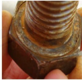
Gambar 2.3 Korosi Celah Pada Baut (Sumber: Studi Efektifitas Literatur Universitas Indonesia. (Online)).
