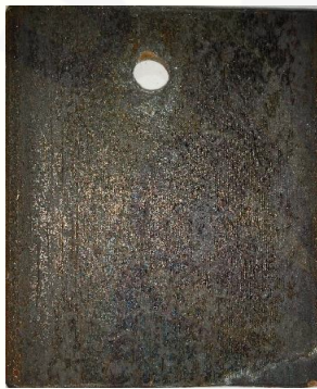
Gambar 4.14 Perbandingan spesimen setelah pretreatment , coating dan salt spray test .
