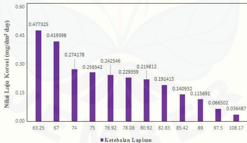
Gambar 4.12 Grafik Nilai Laju Korosi Pada Waktu Pengujian 168 Jam
