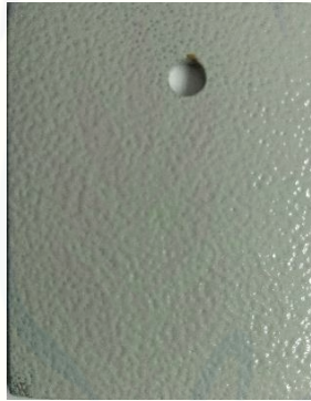
Gambar 4.14 Perbandingan spesimen setelah pretreatment , coating dan salt spray test .
