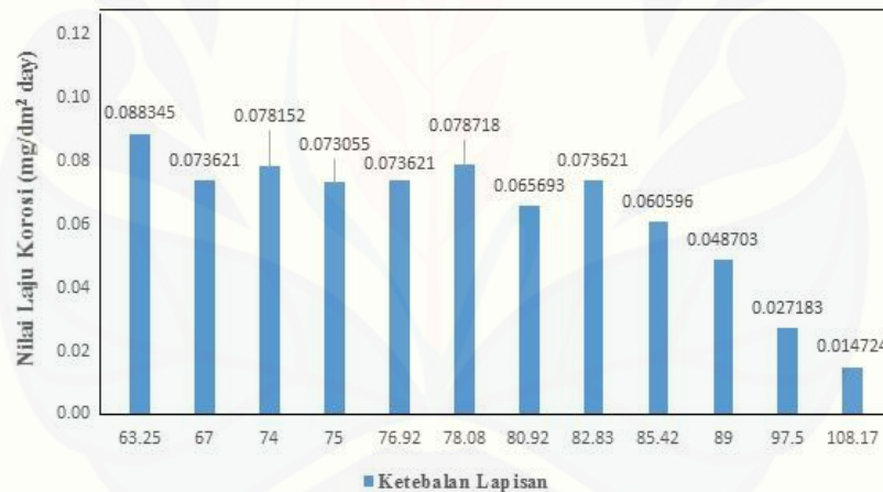
Gambar 4.6 Grafik Nilai Laju Korosi Pada Waktu Pengujian 24 Jam
