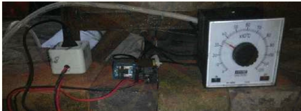
Termocontrol pada alat uji salt spray
