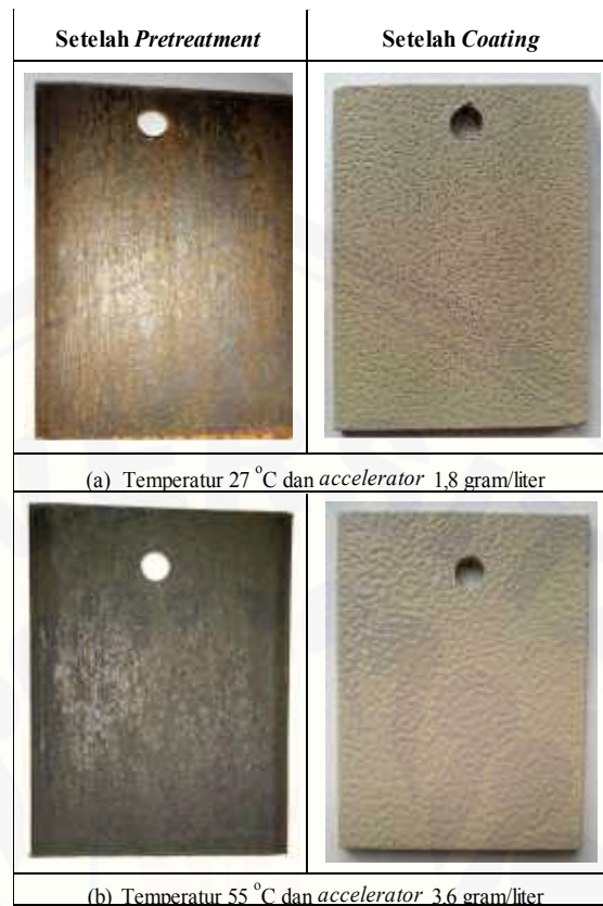
Gambar 4.5 Perbandingan spesimen setelah pretreatment dan setelah coating .
