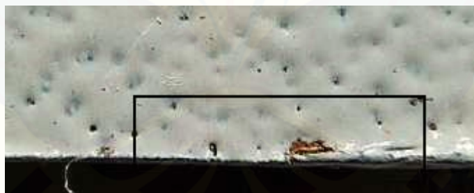
Gambar 4.15 Cacat pinholing foto makro dengan perbesaran 20x.
