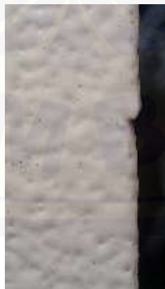
Gambar 4.12 Cacat runs foto makro dengan perbesaran 10x
