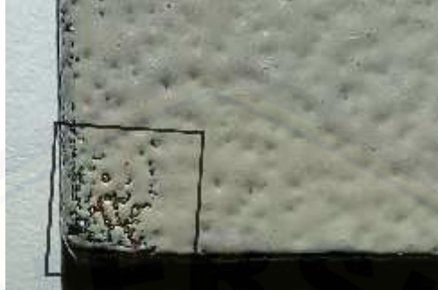
Gambar 4.14 Cacat cracking/crazing foto makro dengan perbesaran 10x.
