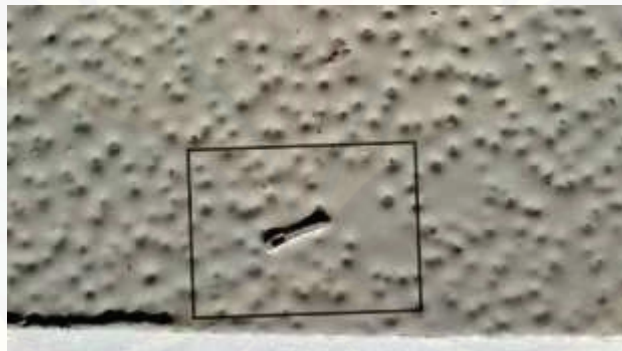
Gambar 4.13 Cacat dirt and dust clear coat foto makro dengan perbesaran 10x.
