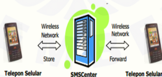
Gambar 2.4 Skema Cara Kerja SMS
