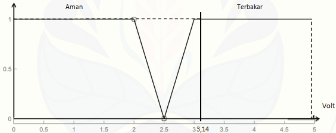
Gambar 4.17 Posisi output sebesar 3,14 volt dalam himpunan IMF of kondisi output
