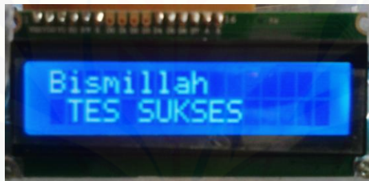
Gambar 4.8 Pengujian tampilan LCD 16x2
