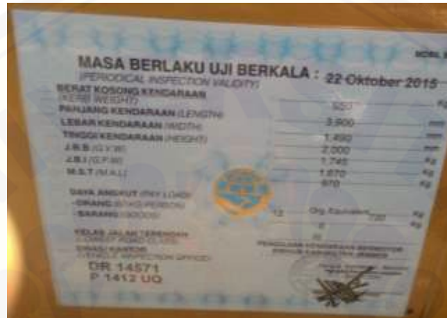
Gambar 4.1 Informasi Data Uji KIR pada badan Kendaraan MPU
