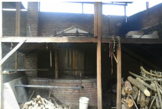
(a) Penyulingan Minyak wangi limbah gaharu
