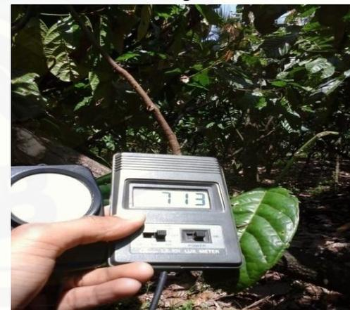
Gambar 6. Pengukuran Intensitas Cahaya Masuk
