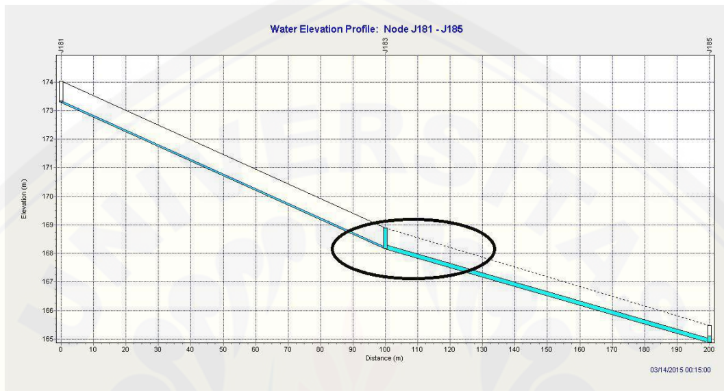
Gambar 4.28 Gambar Running SWMM Jaringan Drainase Merpati 2 Kala Ulang 5 Tahun pada Node J183
