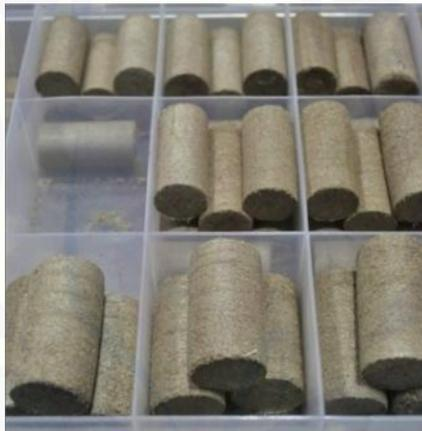
Gambar 4.1 Bentuk fisik briket hasil pencetakan
