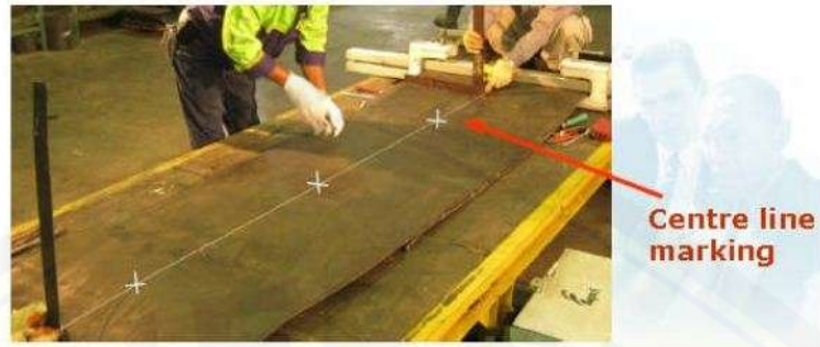
Gambar 3.7 Pembuatan Center Line (Sumber: Summa Learning Center )
