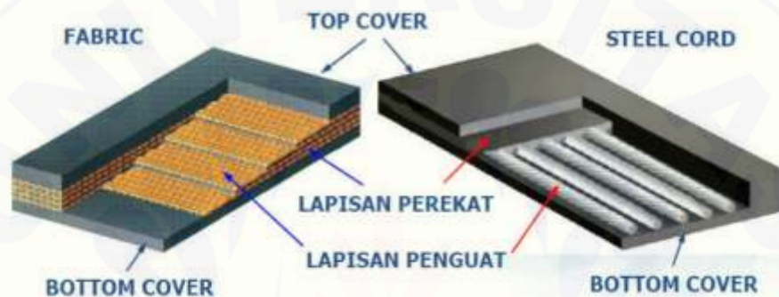
Gambar 2.6 Bagian - bagian belt (Sumber: Summa Learning Center )
