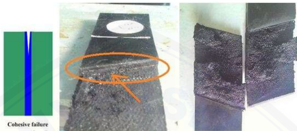
Gambar 4.4 Bentuk kegagalan cohesive
