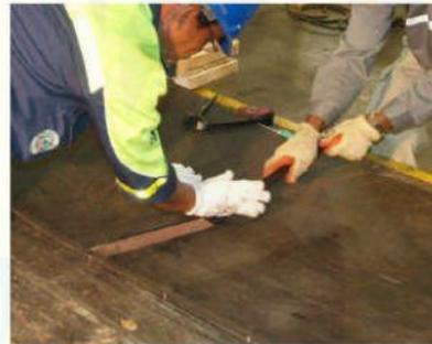
Gambar 3.7 Pemotongan *ply* pada bagian tengah (Sumber: *Summa Learning Center*)
