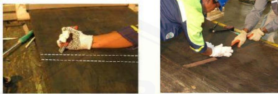
Gambar 2.13 Pemotongan *ply* pada bagian tengah (Sumber: *Summa Learning Center*)
