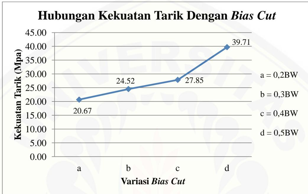
Gambar 4.8 Grafik Hubungan antara nilai kekuatan tarik dengan variasi *bias cut*
