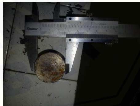
Gambar C.15 Pengukuran diameter dies pejal cetakan
