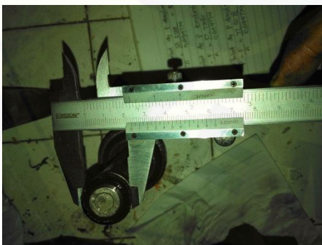
Gambar C.15 Pengukuran diameter piston besar dongkrak hidrolik
