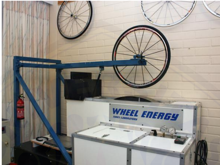
Gambar 2.7. Contoh gambar alat uji rolling resistance
