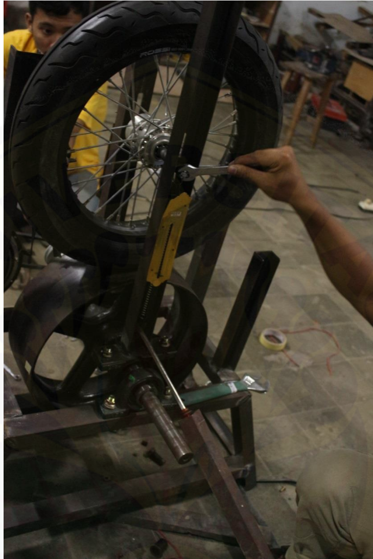
Gambar 4.2. Pemberian Beban ( W ) 2 \times 500 N pada poros roda
