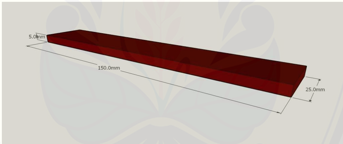
Gambar 3.4 Bentuk dan ukuran spesimen uji tarik
