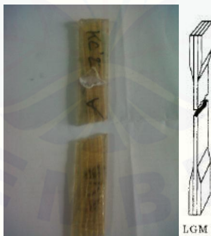
Gambar 4.9 Bentuk patahan spesimen dengan kode LGM
