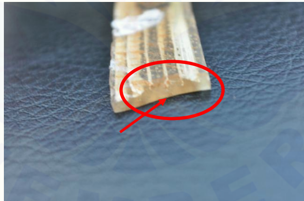
Gambar 4.15 Penampang patah getas pada pengujian tarik
